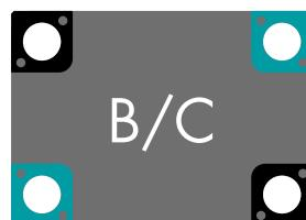
Die Abstände der Führungsbohrungen zu den Außenkanten sind identisch. Die Druckplatten sind in allen vier Positionen austauschbar.
